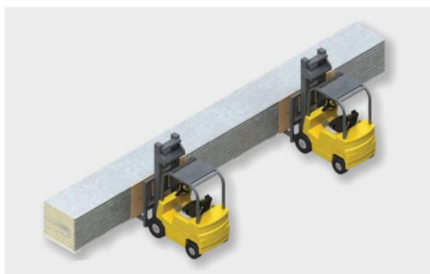
(ukážka vykladania panelov s dvomi vysokozdvížnymi vozíkmi)
