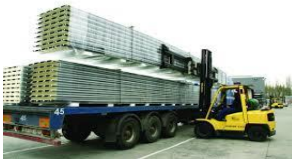
(ukážka vykladania panelov vysokozdvížnym vozíkom)
