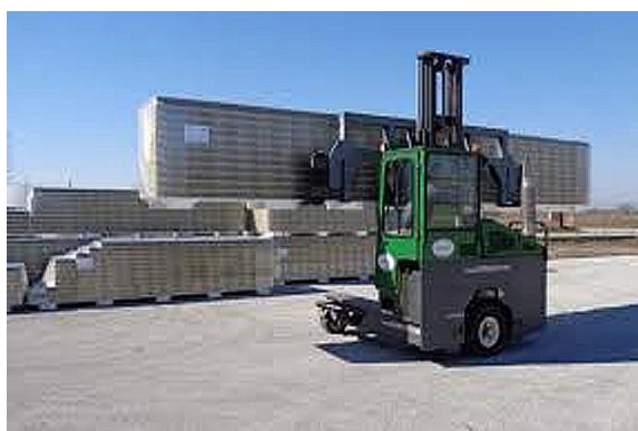
(ukážka vykladania panelov bočným vysokozdvížnym vozíkom)
